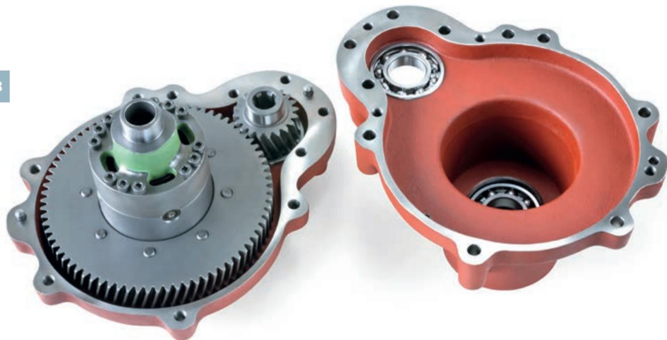
L'image en haut montre un boîtier d'axe central avec un jeu de pignons droits à denture oblique et différentiel. Des chargeuses sur roues, des petites machines qui sont utilisées dans les étables, et qui disposent d'une largeur de voie particulièrement petite, afin de passer à travers les ouvertures de portes.
